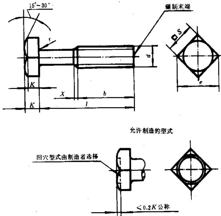
末端按GB 2规定：无螺纹部分杆径约等于螺纹中径或等于螺纹大径。
